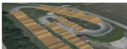
La formation des bosses en terre, la pose d'une sous couche drainante de 270 tonnes et d'un revêtement sable calcaire de 210 tonnes ont été mises en place. Enfin, des finitions
